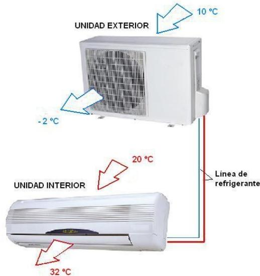
En este modo de funcionamiento (calefacción) es común que un equipo con bomba de calor presente algunos problemas.
