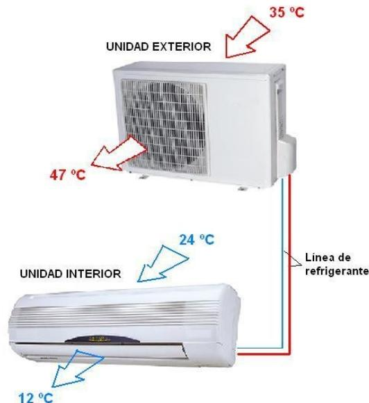
En la nueva figura es el esquema del equipo trabajando en el modo calefacción. En este caso para calentar el aire del local con la unidad interior, es necesario que simultáneamente la unidad exterior enfríe el aire “de la calle”.
